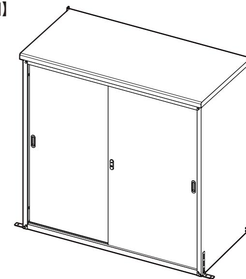
※戸当たり部と扉の間に隙間ができる場合、底板の水平が取れておらず、収納庫がねじれていることが原因と考えられます。収納庫が水平になるよう調整してください。
