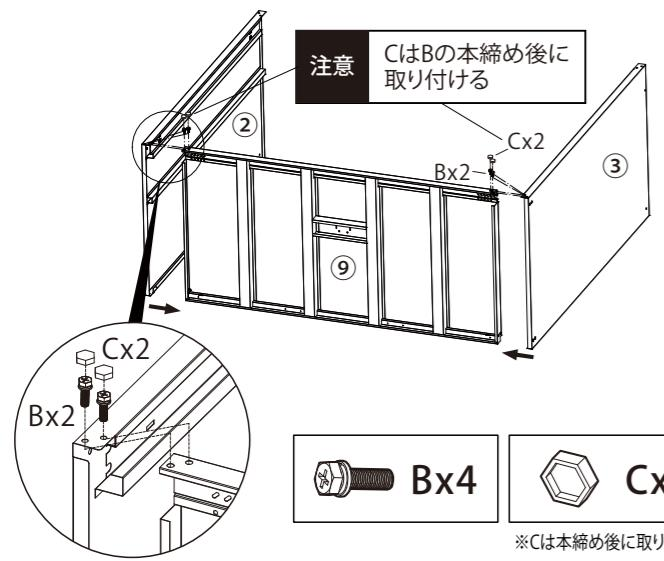
**2** ①に⑥上部レールを内側から当ててB.ボルト各2本で②、③と固定し、①で仮締めした箇所を本締めする。
