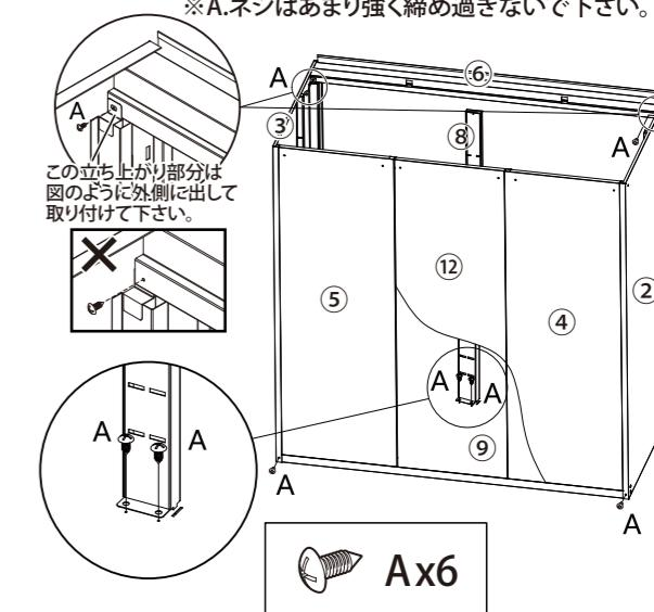
**5** ①天板の向きに気を付けのせ、図の通り内側からA.ネジで11カ所固定し、J.扉クッションを取り付ける
